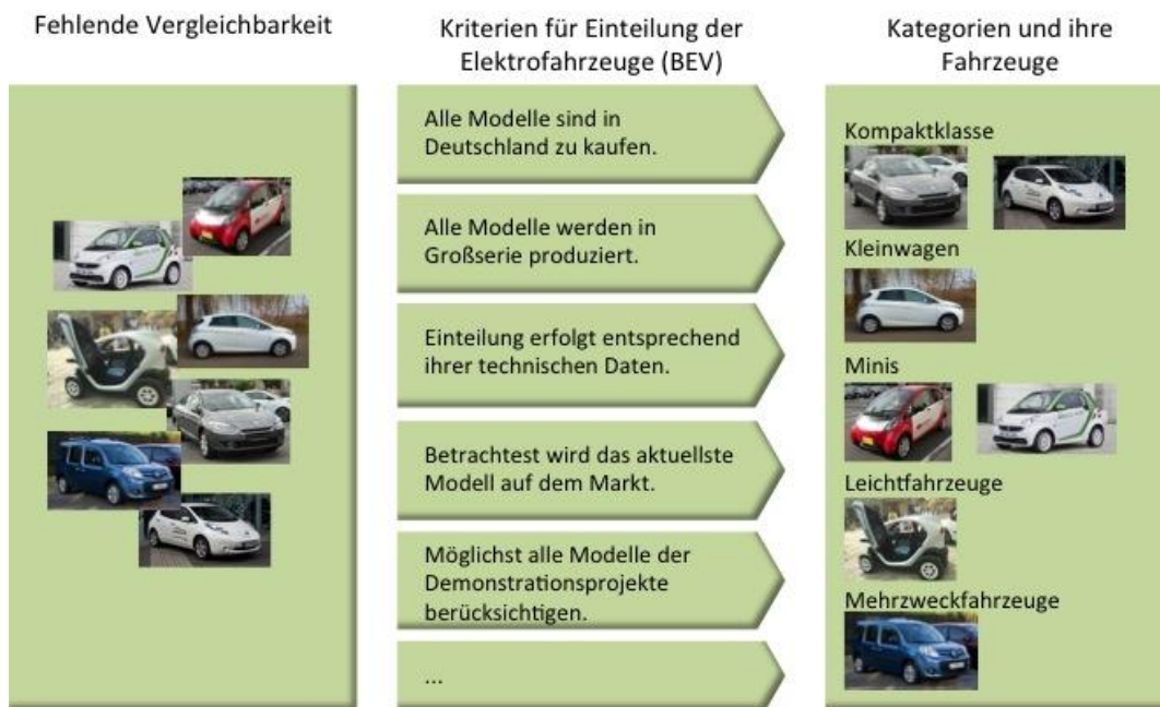
Abbildung 5: Kriterien zur Auswahl der BEV und Einteilung der Fahrzeugkategorien zum Aufbau des Datenmodells
