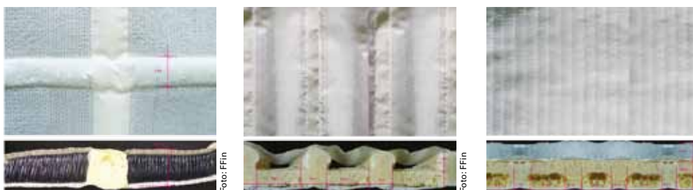
Geschäumte Abstandsgewirke und -gewebe im Maßstab 1:1 in einer Größe von ca. 30 x 40 cm
