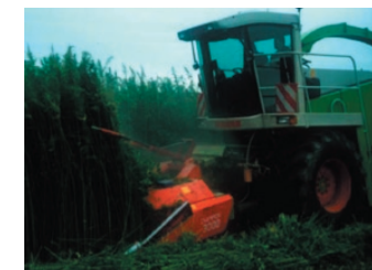
Hanfschneidwerk: Ablage von eingekürztem Stroh zur Röste
