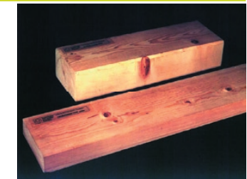
Abb. 1 Fichte-Kantholzquerschnitt vor und nach der Verdichtung
