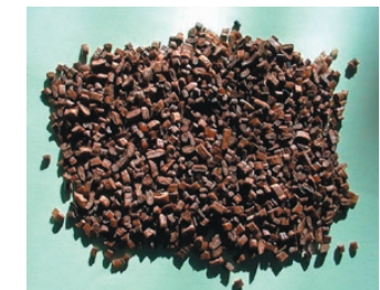
Spritzgießgranulat mit Ölfasern
