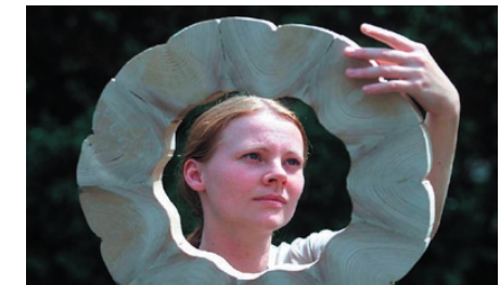
Abb. 6 Prozess zur Herstellung geformter Holzprofile aus Kant- und Rundholz Abb. 7 Ringförmiger Querschnitt aus verdichteten Halbrundhölzern
