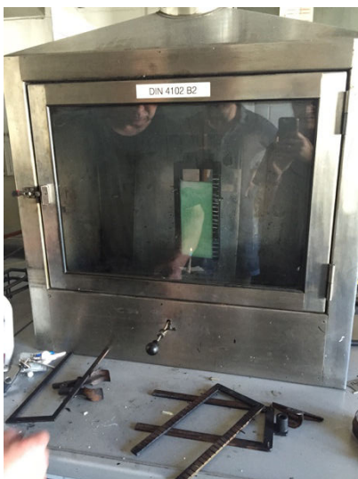
Abb. 2 Brennkasten B2 Prüfung
