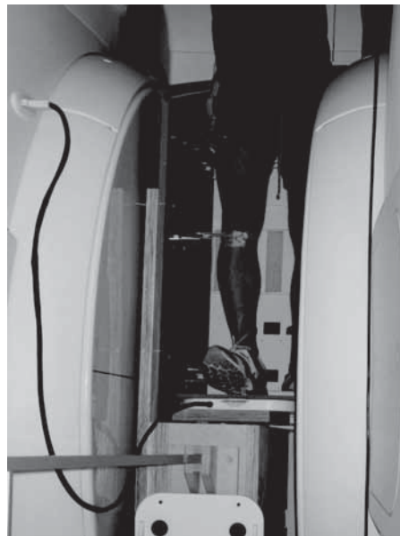
Abb. 2: MRT-taugliche Vorrichtung für Beinbewegungen mit integriertem Bodenreaktionskraftmesser in einem Upright-MRT
