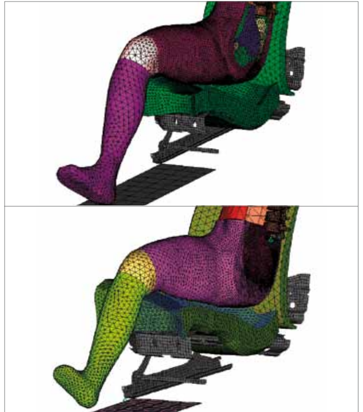
Männliches und weibliches Boss-Modell im Schnitt (oben und unten) mit jeweils formoptimierter Oberfläche eines Autositzes
