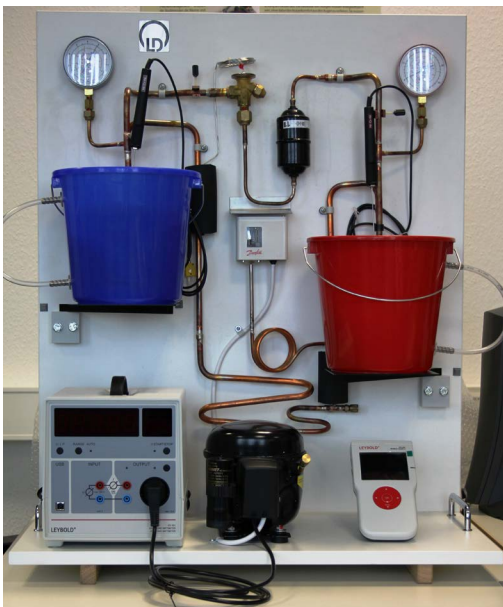
Abb. 14 Versuch Wärmepumpe, © Kotic
